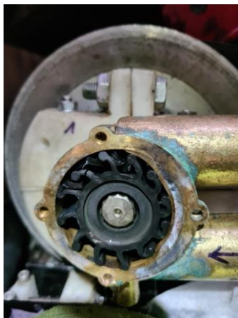
Bild: Manchmal findet man wahre Schätze beim Impellerwechsel, wie hier die Überreste eines alten Impellers vom Vorbesitzer
