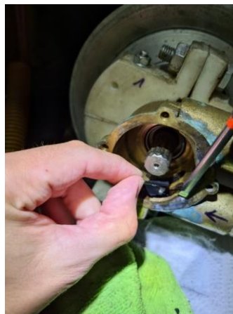
Bild: Manchmal findet man wahre Schätze beim Impellerwechsel, wie hier die Überreste eines alten Impellers vom Vorbesitzer
