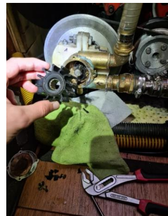
Bild: Manchmal findet man wahre Schätze beim Impellerwechsel, wie hier die Überreste eines alten Impellers vom Vorbesitzer
